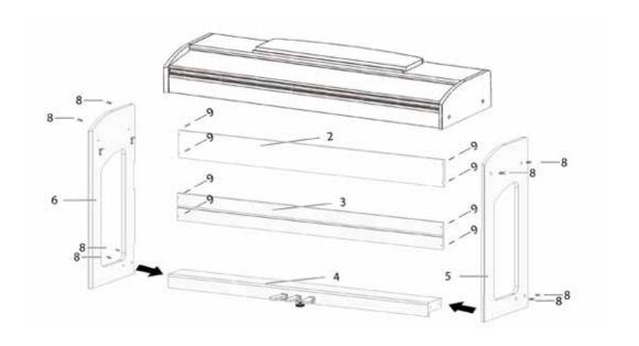
9. Stellen Sie Ihr Digitalpiano an den gewünschten Ort und drehen Sie die Stellschraube (13) unter dem Pedalboard (4) so weit heraus, dass diese den Boden berührt.
